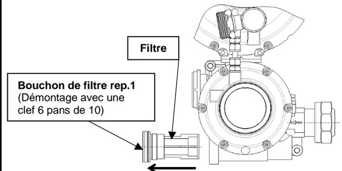
Positionner le régulateur afin de permettre le démontage du filtre comme indiqué sur le schéma ci-dessus.
