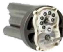
outils spécifiques. Cette cartouche de mesure innovante de Pietro Fiorentini simplifie la plupart des activités de maintenance et de réparation. Les techniciens peuvent enlever la totalité du mécanisme de mesure (rotors, engrenages de distribution et paliers) du corps du compteur, en une seule pièce. Que vous souhaitiez nettoyer la cartouche et la réinstaller, ou la remplacer, les réparations majeures sont rapides et faciles.
