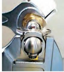
Mettre en place et fixer le boîtier dans la cloison puis la vanne dans le boîtier. Ne pas serrer trop fort pour ne pas détériorer les pièces en plastique.
