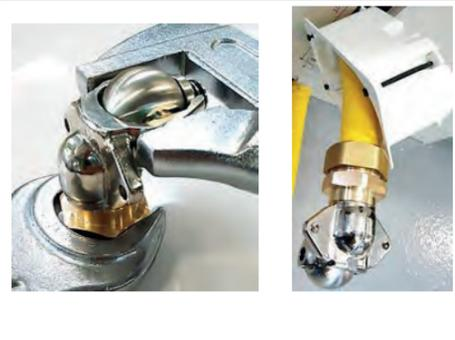
⚠ Orienter correctement la vanne au moment de serrer l'écrou.
