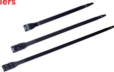
Les colliers existent en 3 longueurs : 180, 260 et 360 mm. Ils disposent d'un crantage extérieur. Leur température d'utilisation est comprise entre -45°C et +85°C. Ils ont une bonne résistance aux UV, graisses, huiles, hydrocarbures et peuvent s'utiliser en intérieur et extérieur.
