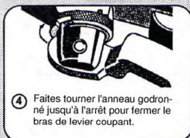
④ Faites tourner l'anneau godronné jusqu'à l'arrêt pour fermer le bras de levier coupant.
