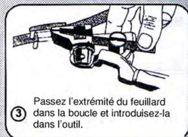
③ Passez l'extrémité du feuillard dans la boucle et introduisez-la dans l'outil.
