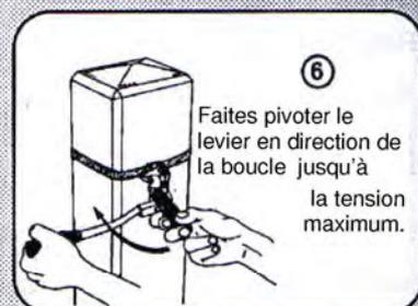
⑥ Faites pivoter le levier en direction de la boucle jusqu'à la tension maximum.
