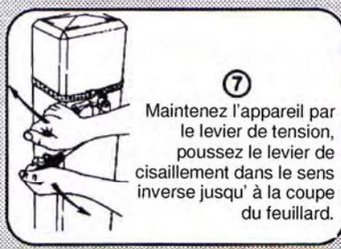
⑦ Maintenez l'appareil par le levier de tension, poussez le levier de cisaillement dans le sens inverse jusqu'à la coupe du feuillard.
