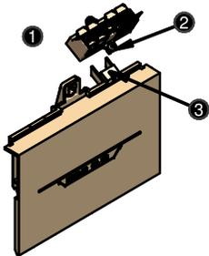
➔ Si besoin fixer le dispositif non fourni (1) à l'aide d'une seule vis (2) sur l'appui incliné (3), situé sur le côté gauche de la plinthe
