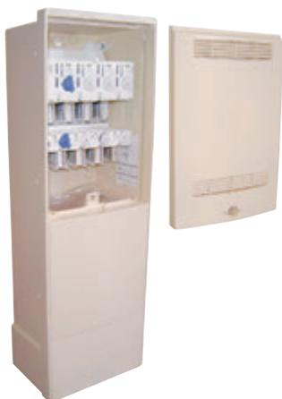
La borne est installée en émergence et le Coffret en encastrement sur les réseaux BT. Le produit permet la coupure 100 A grâce aux barrettes de sectionnement Taille 00 ou la protection 100 A grâce à des fusibles 100 A Taille 00.
