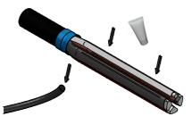
2 Enfiler la gaine sur le conducteur puis la découper à la longueur souhaitée. (Astuce : Tourner la gaine sur le conducteur pour faciliter le glissement.)
