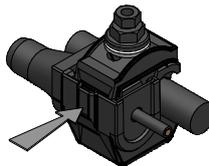
**3** Serrer avec la clé 6 pans pour tête hexagonale de 13 jusqu'à rupture de la tête fusible.
